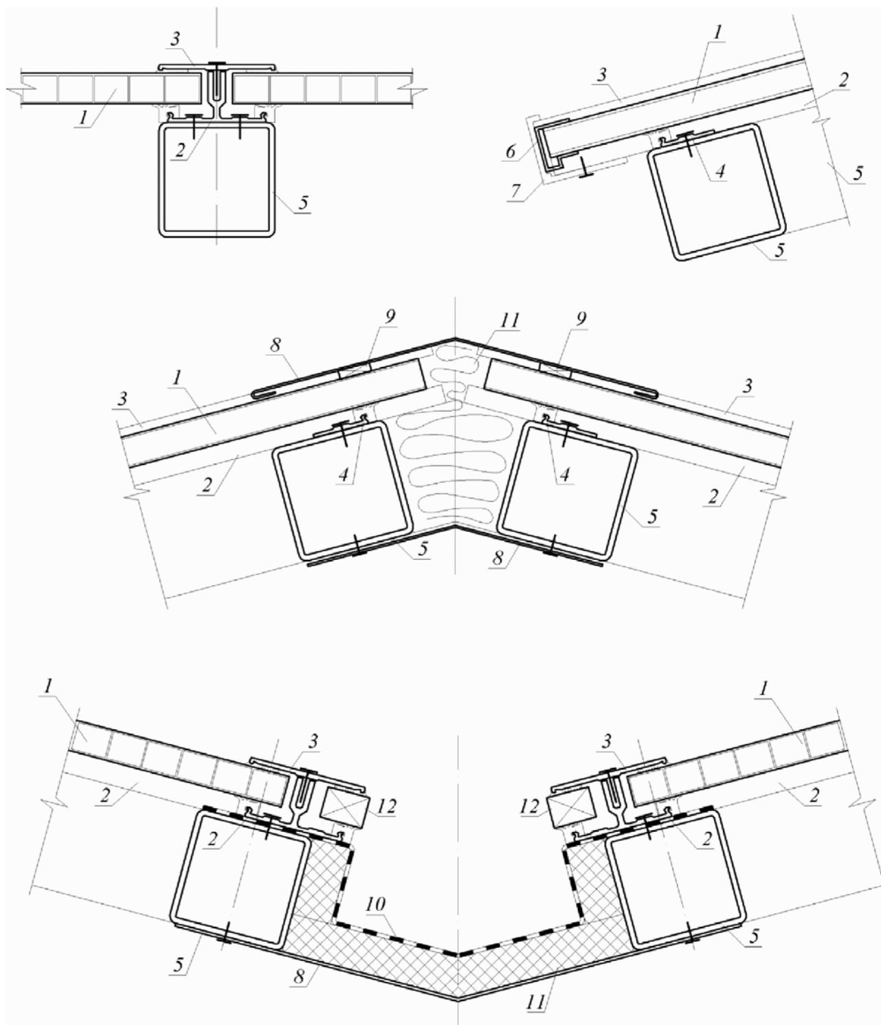
1 - поликарбонатная панель; 2 - базовый алюминиевый профиль с резиновым уплотнителем; 3 - прижимной алюминиевый профиль с резиновым уплотнителем; 4 - алюминиевый профиль с резиновым уплотнителем; 5 - элемент металлического каркаса; 6 - торцевой профиль; 7 - фиксатор торцевого
